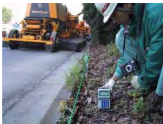
写真－3.4 沿道の温度測定状況
